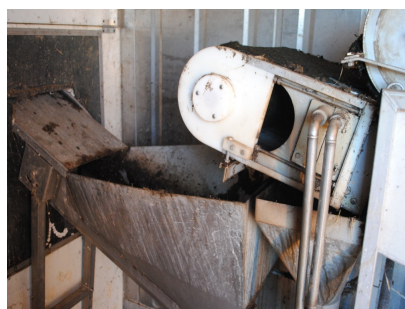
Figur 2. AL-2 båndfilteranlæg med tilsætning af polymer. Fiberfraktionen snegles til lukket container (foto til venstre). Under omrøring tilsættes polymer til rågylle, som derefter føres gennem båndfilteret (foto til højre) (Foto: Allan K. Olesen)
