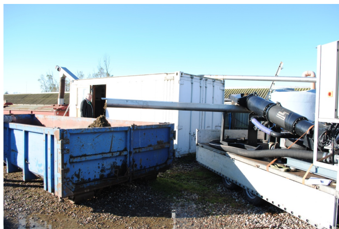
Figur 1. Agrometer skruepressen, hvor fiberfraktionen snegles til container (Foto: Allan K. Olesen)
