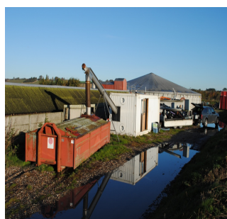
Figur 2. AL-2 båndfilteranlæg med tilsætning af polymer. Fiberfraktionen snegles til lukket container (foto til venstre). Under omrøring tilsættes polymer til rågylle, som derefter føres gennem båndfilteret (foto til højre) (Foto: Allan K. Olesen)
